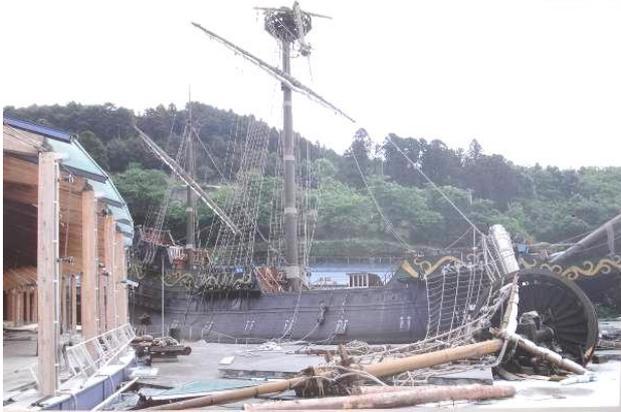
図7 3.11の震災後の強風時にフォアマストが折れたサンファン・パウティスタ号。サンファン館の展示写真より（筆者撮影）
